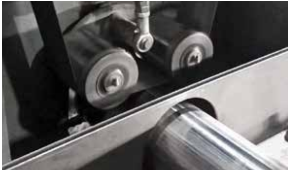
Schleifen von Längsnaht bei geschweißten Rohren
