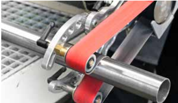
Rundschleifen von Rohren und Stangen mittels Powertools
