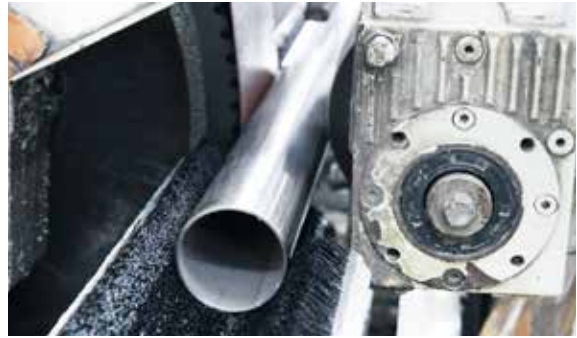
Rundsleifen von Rohren und Stangen im Centerlessverfahren
