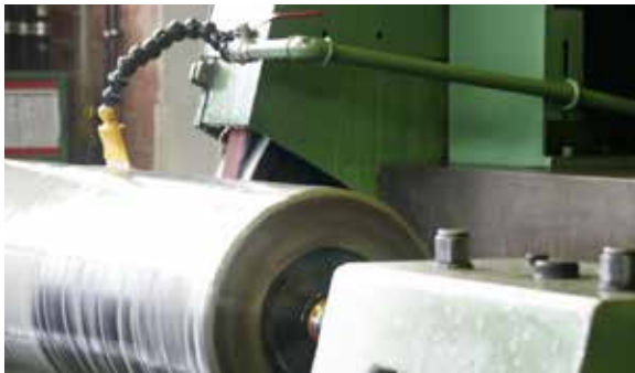
Rundschleifen von Kolben und Zylindern z.B. zwischen Spitzen
