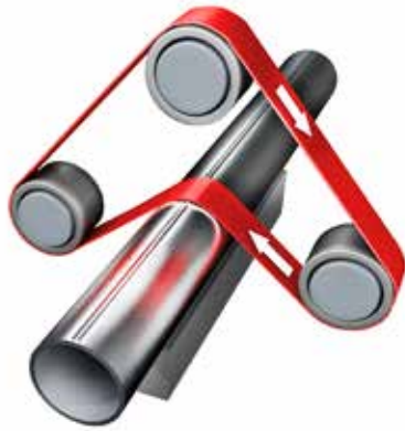
Schleifen von Längsnaht bei geschweißten Rohren
