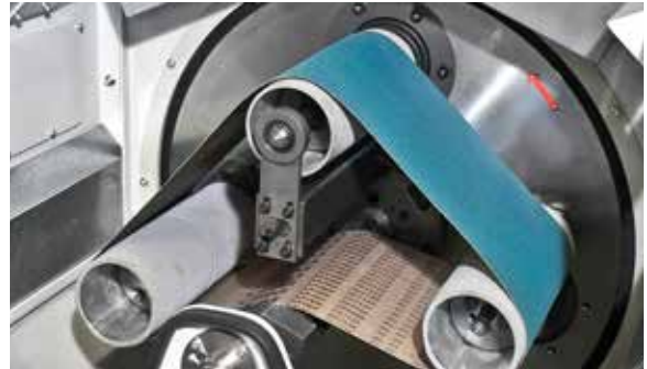
Entzundern von Drahtcoils mittels Planetenschleifverfahren
