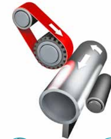
Rundsleifen von Rohren und Stangen im Centerlessverfahren
