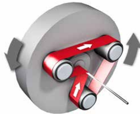
Entzundern von Drahtcoils mittels Planetenschleifverfahren
