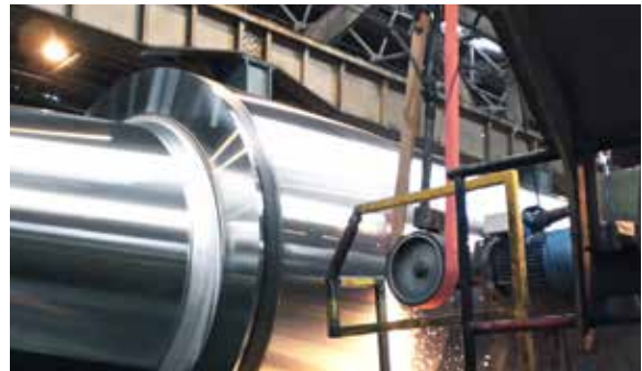
Rundschleifen von Walzen z.B. auf Rollensupports
